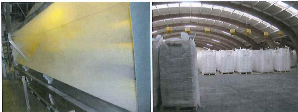
Figure 12: Cuisson des pommes de terre et frites non conformes, pour la production de flocons. Stockage des big bags de flocons en silos (source : INCITEC)
