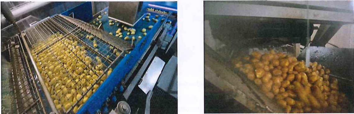
Figure 9: Gauche : calibreur-trieur (source : « 7 sur 7 », 2017) Droite : pelage des pommes de terre sous jet de vapeur (source : INCITEC)
