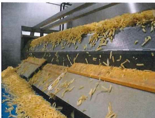
Figure 11: Séchage des frites avant cuisson à l'huile végétale (source : INCITEC)
